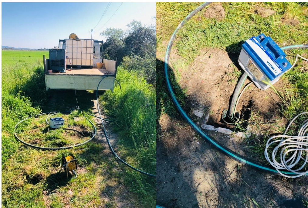
Figura 4a – Spurgo forzato del PZ10
